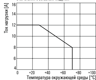
Кривая ухудшения характеристик в сочетании с вставным модулем
