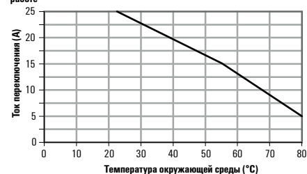
Кривая ухудшения характеристик без вентиляции и при постоянной работе
